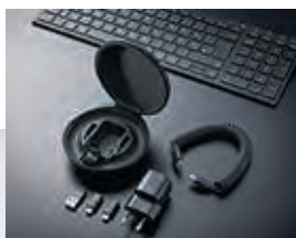
Das Hartschalen-Etui enthält: 30 W GaN-Steckernetzteil, USB-C-Spiralkabel (mit bis zu 60 W Ladeleistung) sowie je 1 USB-A-, Micro-USB- und Lightning-Adapter.
